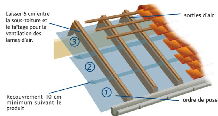
La sous-toiture doit être prolongée hors œuvre soit en bavette dans la gouttière soit fixée sur le bandeau de la rive d'égoût soit arrêtée à l'aplomb d'une fente linéaire ménagée pour la ventilation de la toiture.
